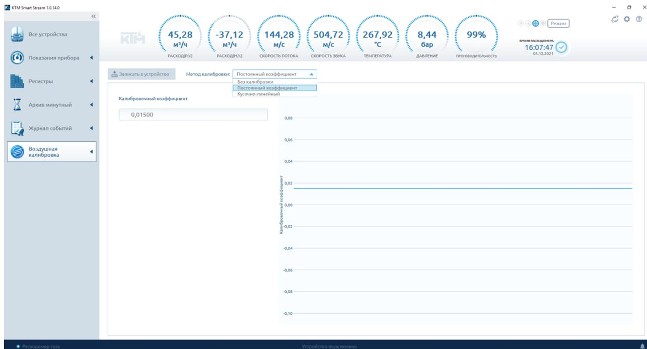
Рисунок 64 – Калибровка постоянным коэффициентом
