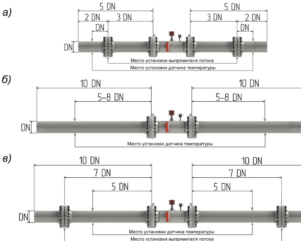
Рисунок 20 – Монтаж счетчика в трубопровод для использования в обоих направлениях
