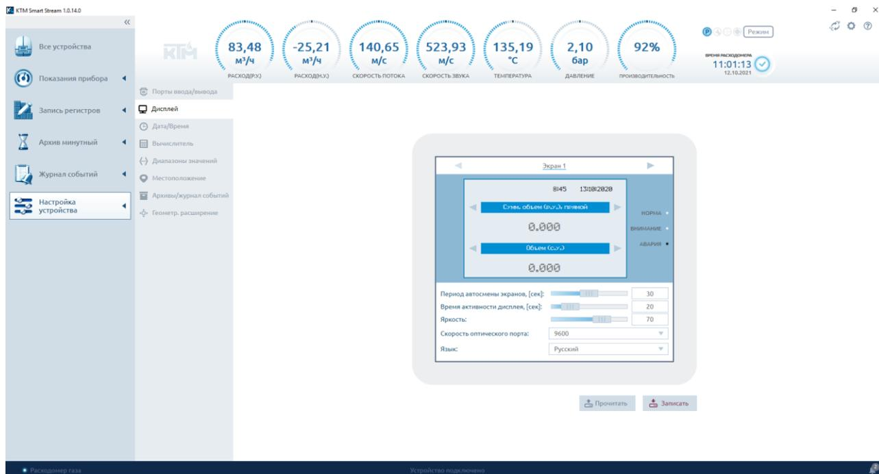
Рисунок 54 – Настройка дисплея счетчика
