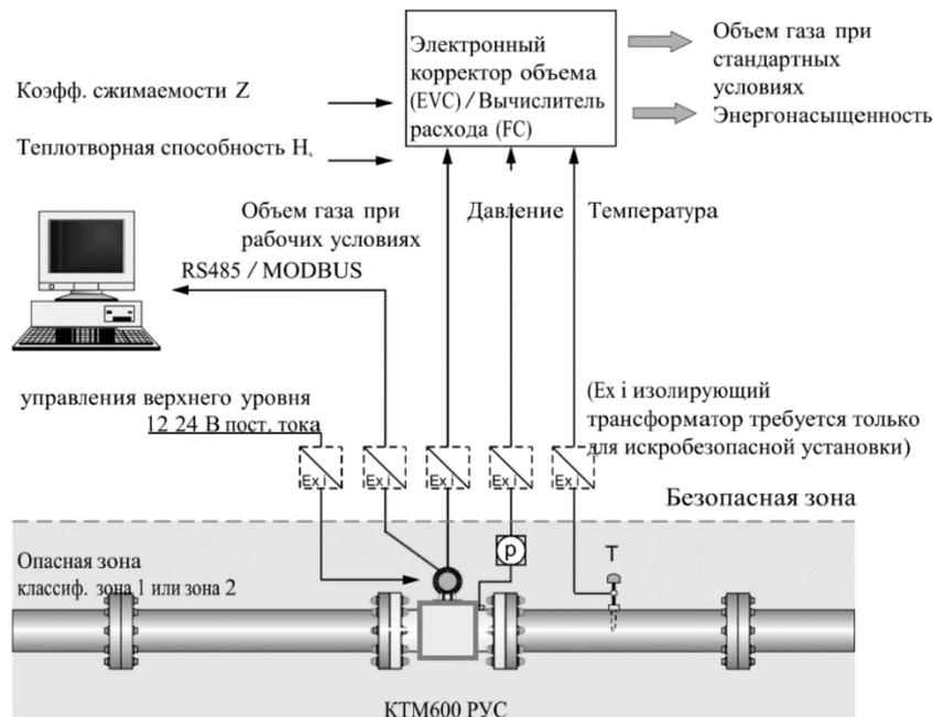
Рисунок 22 – Схема подключения счетчика
