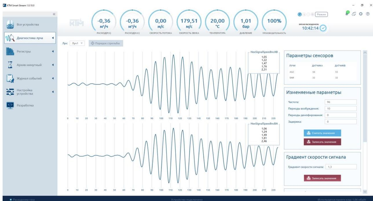
Рисунок 41 – Диагностика ультразвуковых измерительных лучей
