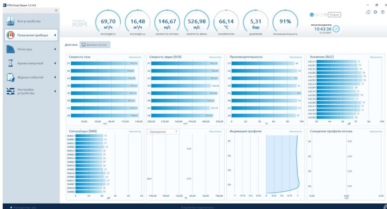
Рисунок 39 – Показания прибора
