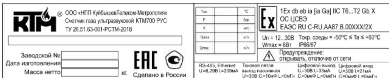
Рисунок 18 – Пример маркировки БОИ КТМ700Н
