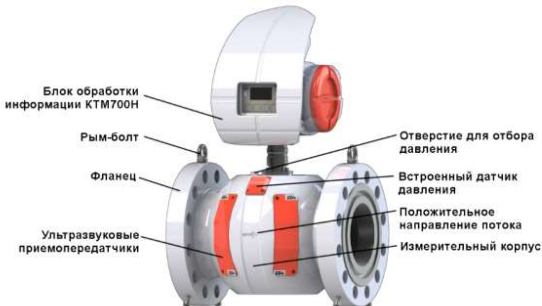
Рисунок 1 – Состав счетчика
