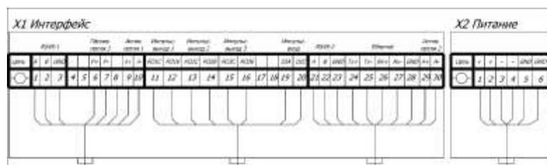
Рисунок 24 – Клеммная коробка БОИ КТМ700Н
