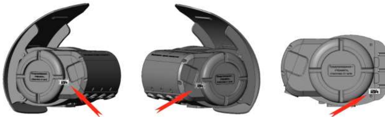
Рисунок 20 – Места пломбирования на корпусе БОИ КТМ700Н
