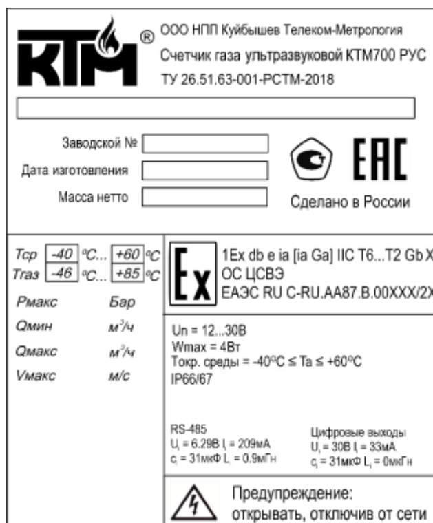
Рисунок 19 – Пример маркировки БОИ КТМ700 Лайт
