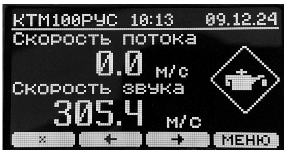
Рисунок 126 – Сигнализация о техническом обслуживании расходомера
