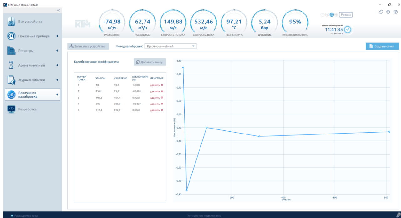
Рисунок 114 – Кусочно-линейный метод калибровки
