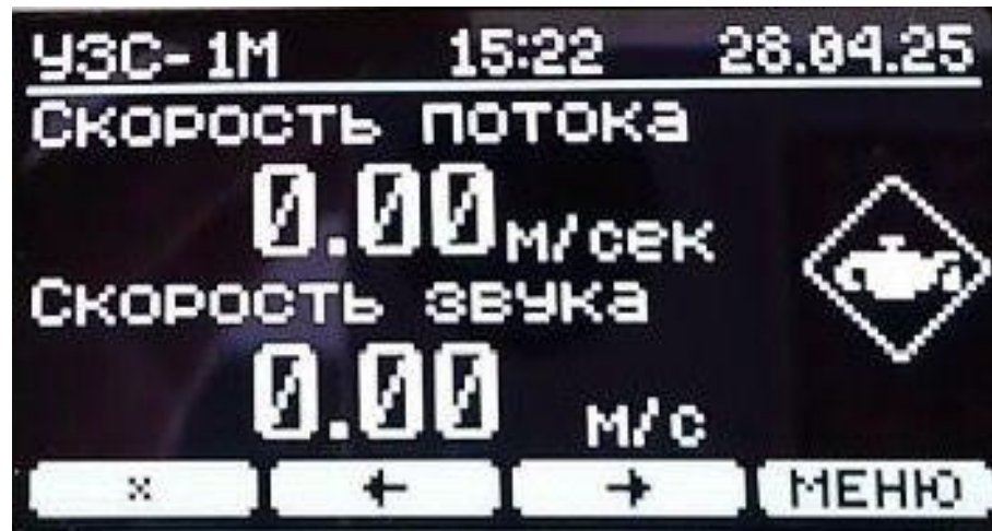
Рисунок 18 – Сигнализация о техническом обслуживании расходомера
