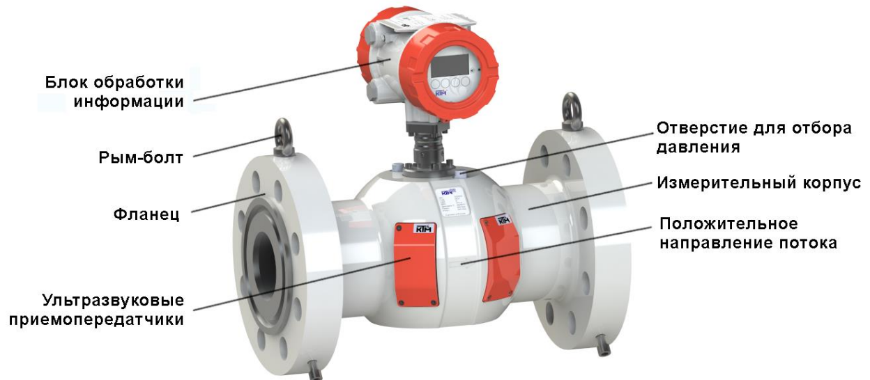
Рисунок 1 – Состав счетчика
