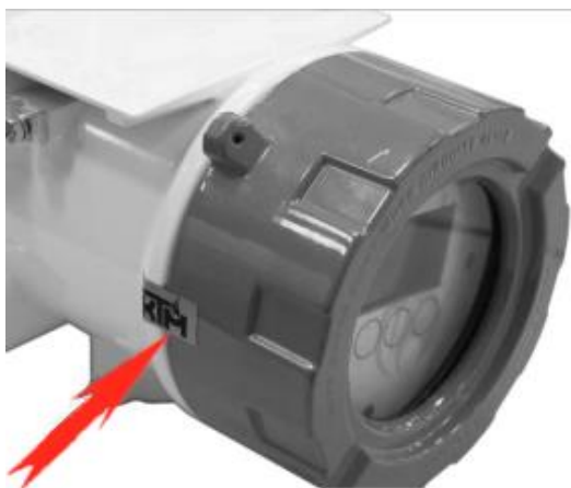
Рисунок 25 – Пример пломбирования переднего отсека БОИ КТМ700 Лайт
