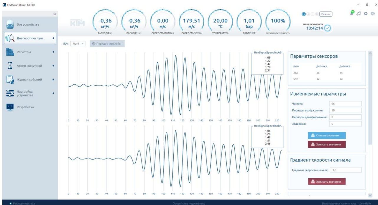
Рисунок 47 – Диагностика ультразвуковых измерительных лучей
