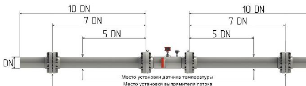
Рисунок 67 – Требования к монтажному месту прибора
