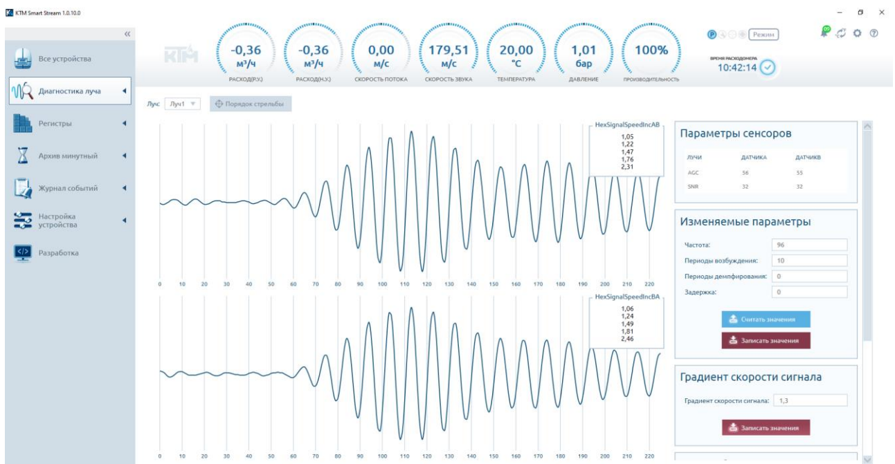
Рисунок 92 – Диагностика ультразвуковых измерительных лучей
