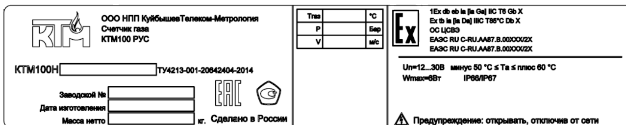
Рисунок 27 – Пример маркировки на БОИ КТМ100Н
