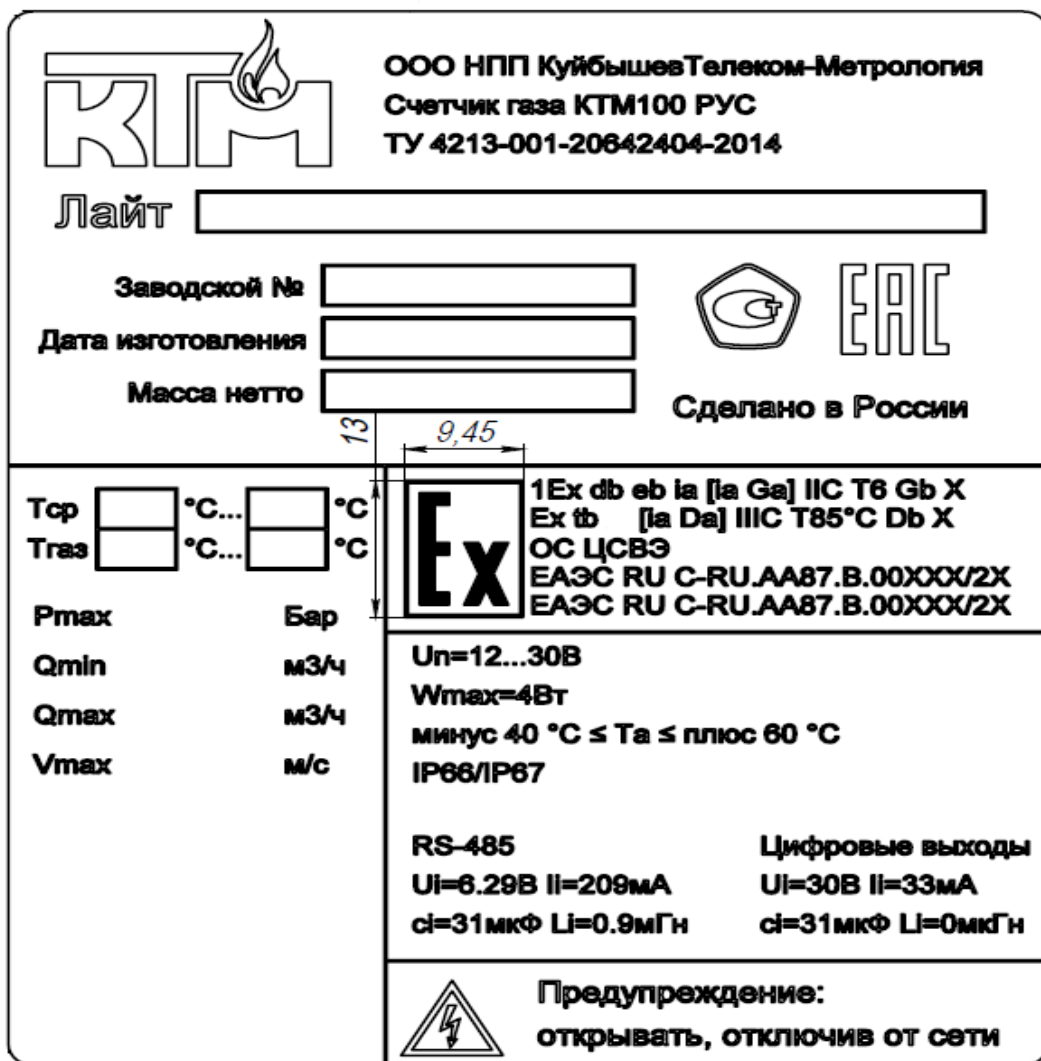
Рисунок 28 – Пример маркировки на БОИ КТМ100 Лайт На крышках отсеков БОИ ударным способом нанесены следующие маркировки: – «Предупреждение – открывать, отключив от сети» - на задней и боковой крышках (рисунок 29); – Знак «Заземление».
